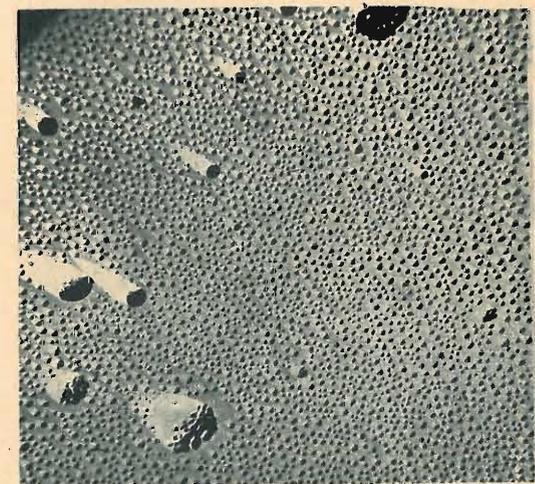
Atomi d'oro vaporizzati nel vuoto vengono proiettati in linea retta; essi colpiscono in tal modo il preparato sotto un angolo molto obliquo e formano così ombre che sono molto intense.
